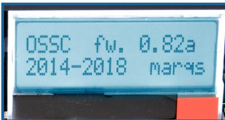
Assicurati che l'alimentatore sia acceso alla parete, quindi accendi il tuo OSSC usando l'interruttore di alimentazione. L'LCD sulla parte anteriore dell'unità dovrebbe illuminarsi e visualizzare la versione corrente del firmware, come mostrato nell'immagine sopra. Una lettera 'a' dopo il numero di versione del firmware indica che il firmware è in grado di supportare l'audio. Passare all'ingresso corretto. Se tutto funziona correttamente, dovrebbe apparire uno schema di test grigio.
