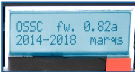
Stellen Sie sicher, dass das Netzteil an der Wand eingeschaltet ist, und schalten Sie dann Ihr OSSC mit dem Netzschalter ein. Die LCD-Anzeige auf der Vorderseite des Geräts sollte aufleuchten und die aktuelle Firmware-Version anzeigen, wie im Bild oben gezeigt. Ein Buchstabe "a" hinter der Firmware-Versionsnummer zeigt die audiofähige Firmware an. Schalten Sie Ihr Display auf den richtigen Eingang. Wenn alles korrekt funktioniert, sollte ein graues Testkartenmuster erscheinen.
