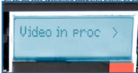
Taste Menu on/off auf der Fernbedienung. Die LCD-Anzeige auf der Vorderseite des Geräts wechselt dann in den Menübetrieb, wie im Bild oben gezeigt. In der neuesten Firmware sind die Optionen nun in Unterkategorien organisiert. Sie können mit den Optionstasten "Zurück/Nächste" auf der Fernbedienung zwischen den Kategorien navigieren und mit der Schaltfläche "OK" eine Option auswählen.
