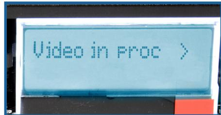
Pour accéder au menu des options OSSC, appuyez sur la touche Menu on/off de la télécommande. L'écran LCD à l'avant de l'appareil passe alors en mode menu, comme illustré dans l'image ci-dessus. Dans le dernier firmware, les options sont maintenant organisées en sous-catégories. Vous pouvez naviguer entre les catégories à l'aide des boutons d'option "Précédent/Suivant" de la télécommande et sélectionner une option à l'aide du bouton "OK".
